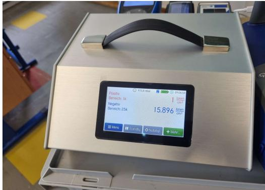
**Bild:** Ionenmessung Punktmessung/mit Ionisat.
