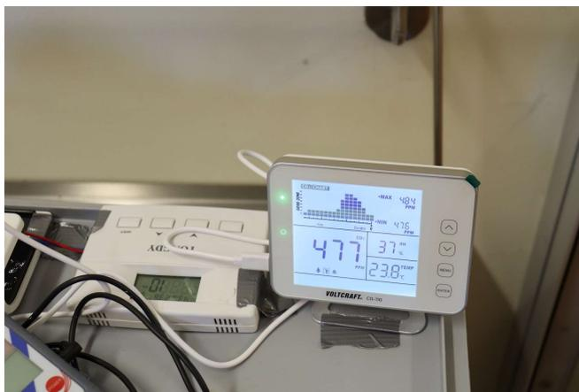
**Bild:** CO<sub>2</sub>; Luftfeucht- und Temp.-Messun
