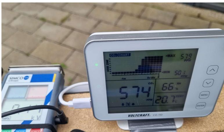
**Bild:** CO2-Messung, Luftfeuchte und Temp.
