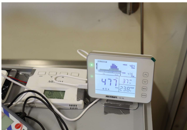
Bild: CO 2 ; Luftfeucht- und Temp.-Messun
