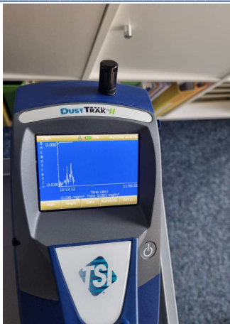
Bild: Dusttrak Aerosolmessungen / mit Ionis.; Kurve von re. nach li. lesen; re. = Flur (ohne Ionis.: li. = Zimmer, ionisiert)
