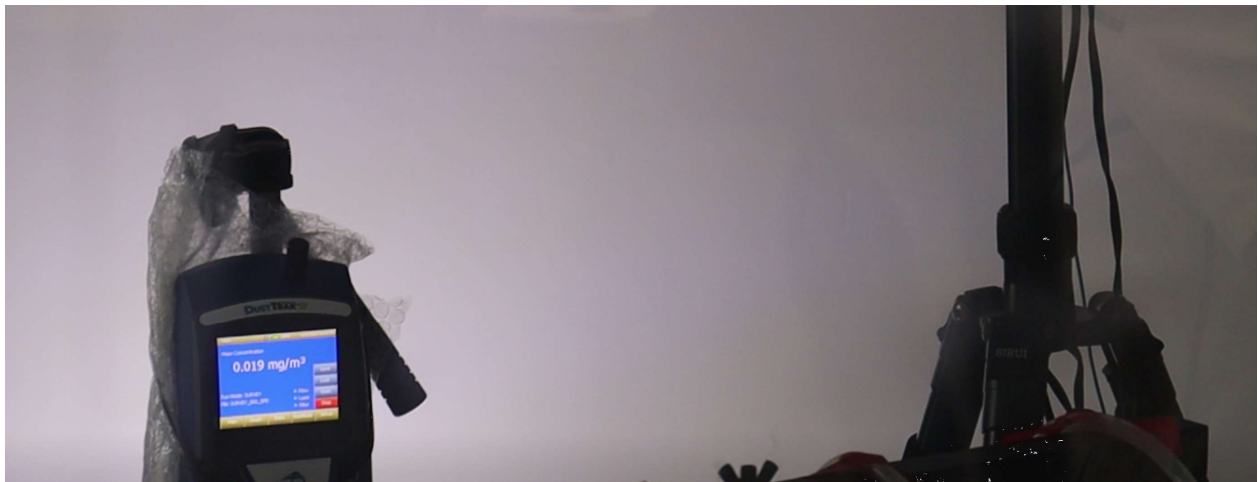
Bild: 17.02.2021 Messungen COVID-Viren und Aerosole ; HygCen GmbH Schwerin; Werte zum Ende der Prüfung – COVID-Surrogate Ausgangsdaten; 2.700.000 /m 3 -- Enddaten 160 /m 3 ; analog verhält sich die Aerosolmessung; Dieser Wert dient nur zum Vergleich der aktuellen Messung
