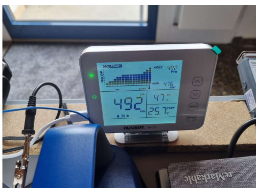
Bild: CO2-Messung, Luftfeuchte und Temp.
