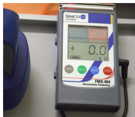
Bild: Feldmeßgerät „SIMCO“
