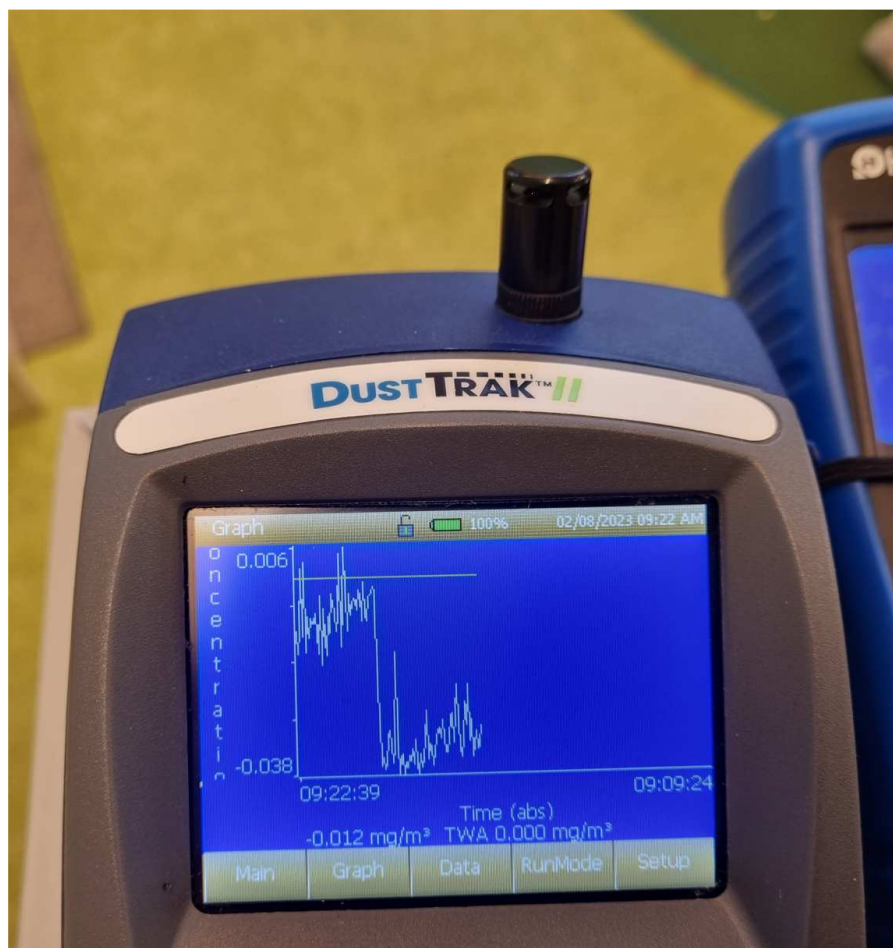
[Bild: Aerosolmessung: Aussenluft - Foyer]
