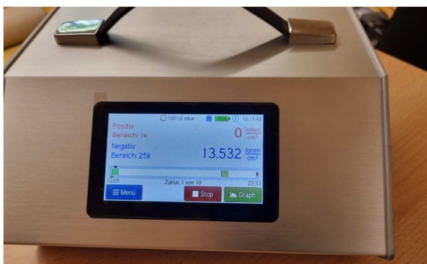
Bild: Ionenmessung Punktmessung
